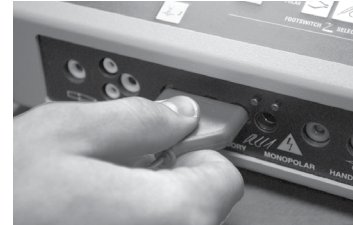
Figura 3. Conectați cablul de alimentare cu 3 pini la generatorul electrochirurgical ales de dvs., (Figura 3). Confirmați că toate setările de alimentare ale generatorului sunt adecvate pentru procedura efectuată. Intensitatea generatorului electrochirurgical trebuie setată la un nivel cât mai scăzut posibil pentru a obține efectul dorit. PlumePen® Elite este un electrod monopolar, este necesară utilizarea unui electrod de dispersie pentru a preveni arsurile/rănirea pacientului. Consultați manualul de utilizare a generatorului electrochirurgical și instrucțiunile de utilizare a electrodului de dispersie pentru instrucțiuni suplimentare.
