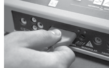
Figur 3. Koble den tregreinede strømledningen til den elektrokirurgiske generatoren du skal bruke (Figur 3). Bekreft at alle strømminstillinger på generatoren er egnet for prosedyren som skal utføres. Den elektrokirurgiske generatorens intensitet skal innstilles til så lavt som er nødvendig for å oppnå ønsket effekt. PlumePen® Elite er en monopolar elektrode, bruk av dispersiv elektrode er nødvendig for å hindre brannskade på pasienten. Se bruksanvisningen for den elektrokirurgiske generatoren og den disperse elektroden for mer informasjon.
