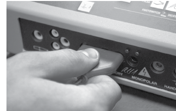
Figura 3. Collegare il cavo di alimentazione a 3 denti al generatore elettrochirurgico scelto, (Figura 3). Verificare che tutte le impostazioni di alimentazione sul generatore siano appropriate per la procedura in atto. L'intensità del generatore elettrochirurgico deve essere impostata sul valore più basso possibile in base alle esigenze per ottenere l'effetto desiderato. Il dispositivo PlumePen® Elite è un elettrodo monopolare, è necessario l'uso di un elettrodo di dispersione per evitare lesioni/ustioni per il paziente. Fare riferimento al manuale utente del generatore elettrochirurgico e alle istruzioni per l'uso dell'elettrodo di dispersione per istruzioni aggiuntive.
