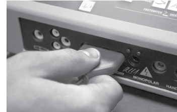
Figur 3. Sæt strømfledningens 3-benede stik i din foretrukne elektrokirurgiske generator (figur 3). Bekræft, at alle strømstillingerne på generatoren er passende for den procedure, der skal udføres. Den elektrokirurgiske generators intensitet bør indstilles så lavt som muligt for at opnå den ønskede effekt. PlumePen® Elite er en monopolar elektrode, og der kræves brug af en spredende elektrode for at forhindre forbrænding/ personskade på patienten. Der henvises til den elektrokirurgiske generators brugervejledning og den spredende elektrodens brugsanvisning for yderligere vejledning.
