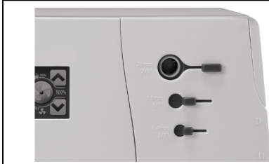
Figura 1. Deschideți ambalajul produsului și scoateți ansamblul creionului chirurgical de evacuare a fumului PlumePen® Elite. Conectați tubulatura livrată împreună cu PlumePen® Elite la un sistem pentru evacuarea fumului sau altă sursă de vid corespunzătoare; exemplu prezentat, (Figura 1). Pentru conectarea și operarea la un anumit sistem chirurgical pentru evacuarea fumului, consultați instrucțiunile specifice de utilizare în vederea configurării și utilizării corespunzătoare.
